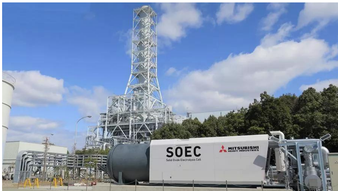
図-2：400kW 容量の SOEC デモ機（高砂水素パーク）
