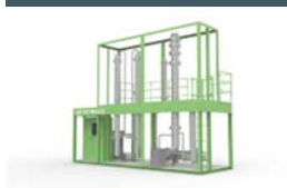
CO 2 回収パイロット試験装置
