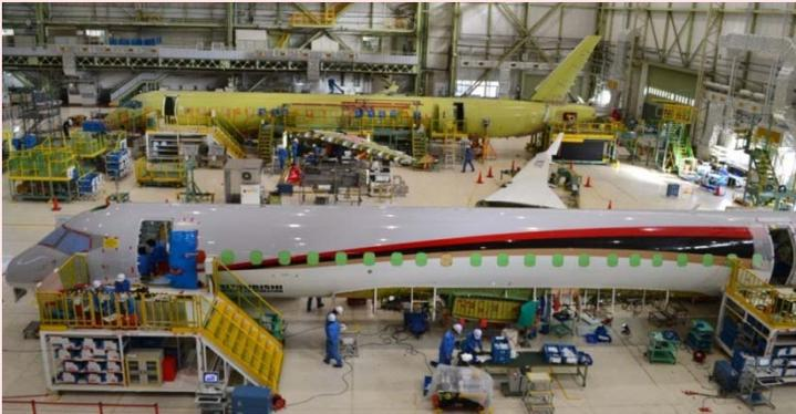
強度試験機・飛行試験機を製造中
