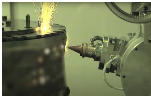
航空機エンジン用硬素材部品の自動加工
