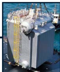
補助ボイラ (九江海天)
