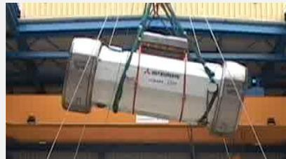
キャスク(実機規模落下試験)
