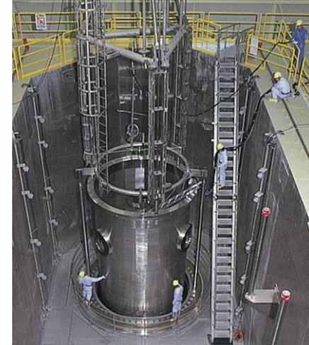
炉内構造物取替工法訓練設備
