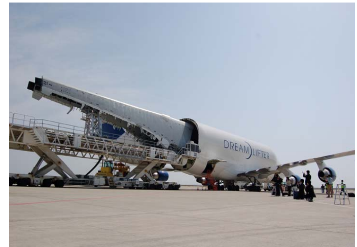
中部国際空港にて空輸のため 主翼を輸送機に搭載中
