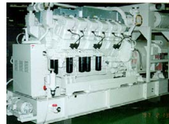
クワ最高熱効率 クリーン排ガスミラーサイクルガスエンジン
