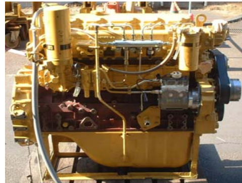
Tier III 対応100kW級 小型エンジン ・高過給技術 ・2006年11月生産開始
