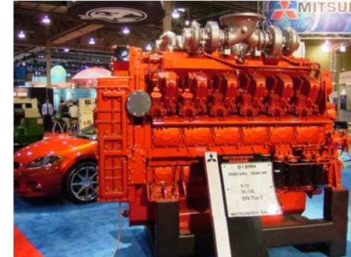
Tier II 対応2000kW級 中大型エンジン ・高圧燃料噴射 ・2007年4月新機種生産開始
