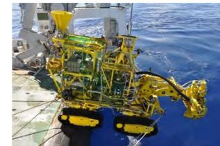
海底資源掘削用集鉱試験機
