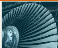
蒸気タービン
