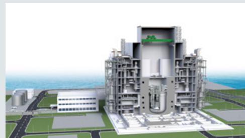
ナトリウム冷却タンク型高速炉 （経済産業省委託事業研究成果を含む）
