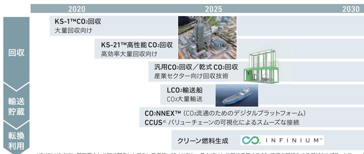
KS-1™、KS-21™：関西電力と共同で開発したアミン吸収液 CO<sub>2</sub>NNEX™：日本IBMと共同で構築するCO<sub>2</sub>流通を可視化するデジタルプラットフォーム
