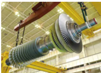
世界最高効率のJ形ガスタービンが実証運転で世界最高のタービン入口温度1,600°Cを達成(2011年)
