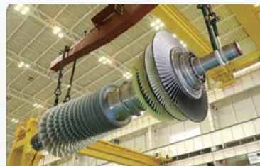
世界最高効率のJ形ガスタービンが実証運転で世界最高のタービン入口温度1,600°Cを達成 (2011年)
