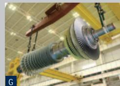
A: 我が国初の鉄製汽船「夕顔丸」建造(1887年) B: 三菱A型乗用車製作(1918年) C: 零式艦上戦闘機製作(1939年) D: 世界最大級コンバインド発電プラント「東北電力、東新潟3号機第二系列545,000kW」完成(1985年) E: H-Iロケット初号機打上げ成功(1986年) F: マレーシア向けCO<sub>2</sub>回収装置引渡し(1999年) G: 世界最高効率のJ形ガスタービンが実証運転で世界最高のタービン入口温度1,600°Cを達成(2011年)
