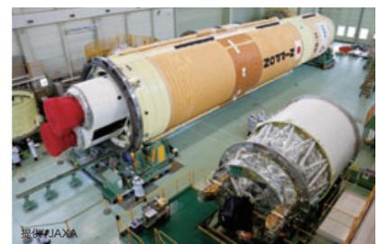
H-IIBロケット3号機コア機体の製造
