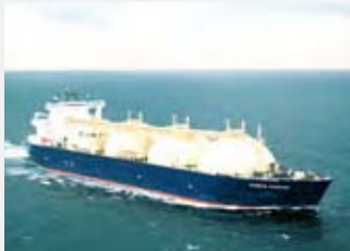
モス方式4タンクLNG船 「CYGNUS PASSAGE」
