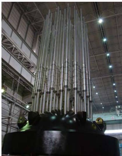
取替用上部原子炉容器
