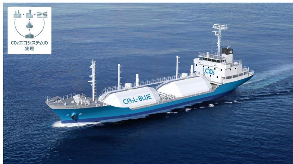
世界初となるCCUSを目的とした液化CO<sub>2</sub>船舶輸送の実証試験船を建造
