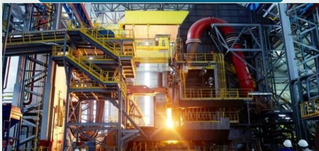
**製鉄機械 (新型電気炉)**
