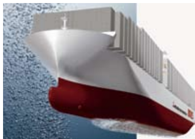
船体と海水の間に空気の層をつくることで、船体の摩擦抵抗を減少させる
