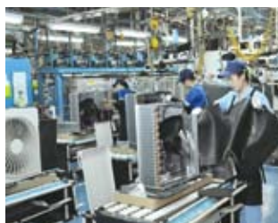
エアコン室外機の組立
