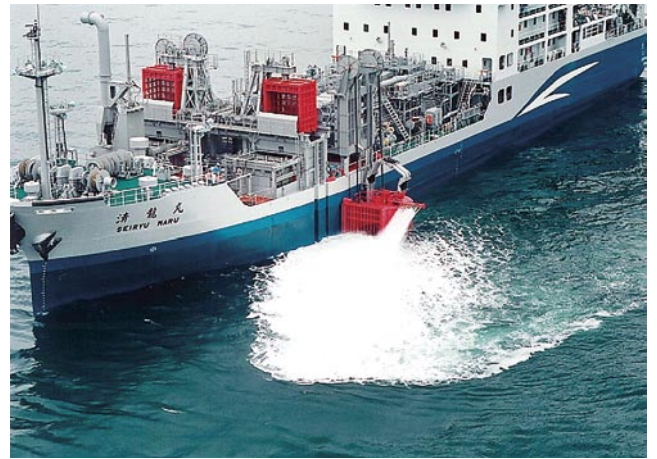
図2 水ジェット式集油装置と油回収装置 波浪中の油回収効率を高めることができる。
