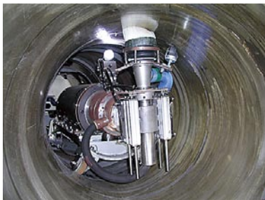
図7 管台内面除染装置試験状況
