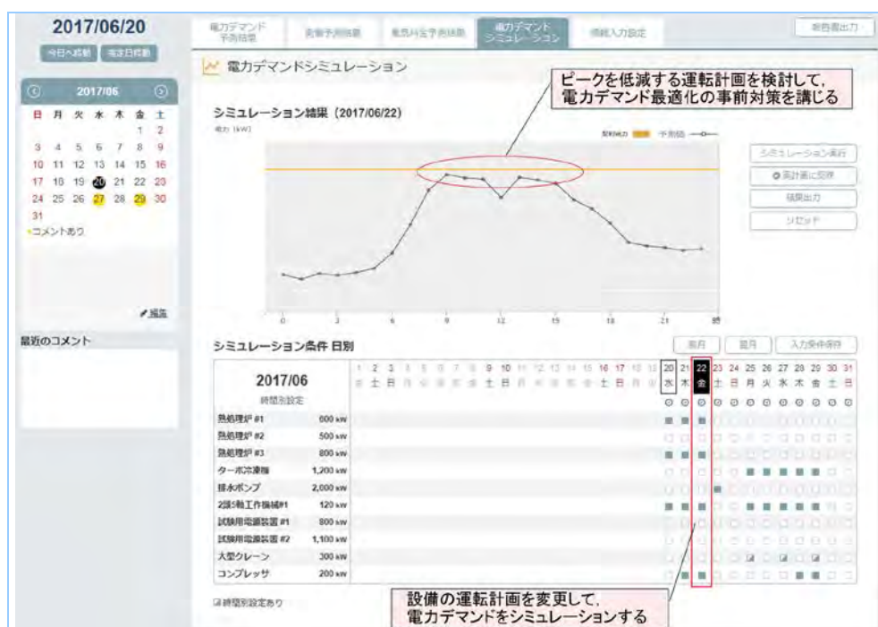
図3 電力デマンド予測システムのシミュレーション機能
