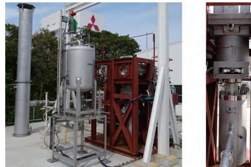
図49 水素ステーション向け液体水素昇圧ポンプ
