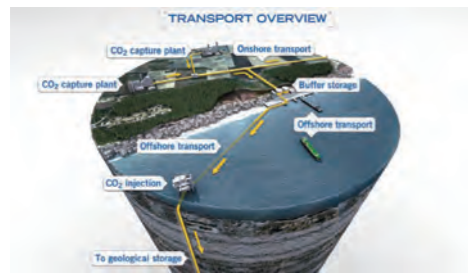
図55 CO 2 輸送の全体像 出展: Fact Sheet Transporting CO 2 , Global CCS Institute
