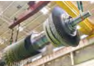
2020 次世代1,650℃級JAC形ガスタービンの長期実証へ向けて高砂製作所GTCC実証発電設備(第二地点)が定格出力達成
