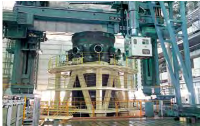
大型複合工作機械 スーパーミラー（原子炉容器機械加工）
