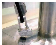
超音波による 内部欠陥検出技術（超音波）
