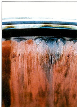
主燃焼室壁面の溶損による周囲の水素冷却配管の破損
