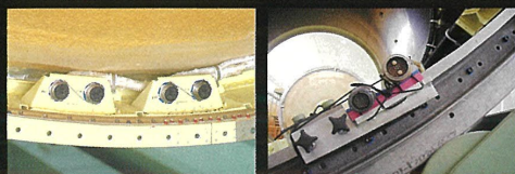
第1、2段分離コネクタ:2段側 (左:H-II、右:H-II A)
