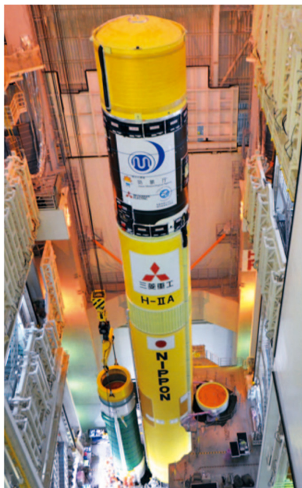
固体ロケットブースタの起立作業状況
