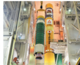
機体組立作業 （固体ロケットブースター結合）
