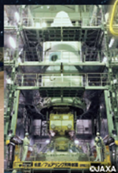
搭載する衛星をフェアリングに収納
