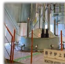
原子炉機器実機大モックアップ （プラント保全技術実習）
