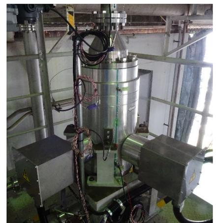
低温余热ORC涡轮发电机外观
