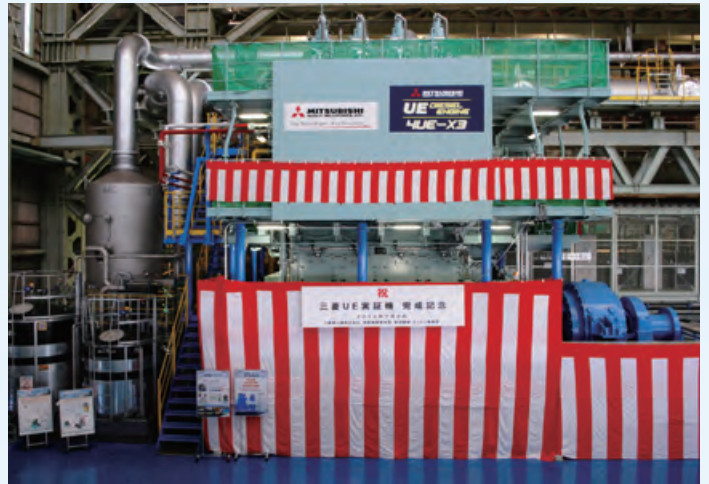
선박용 저속 엔진-전면적 시험 설비 「4 UE-X3
