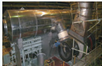
装配 VTI 增压器的发动机
