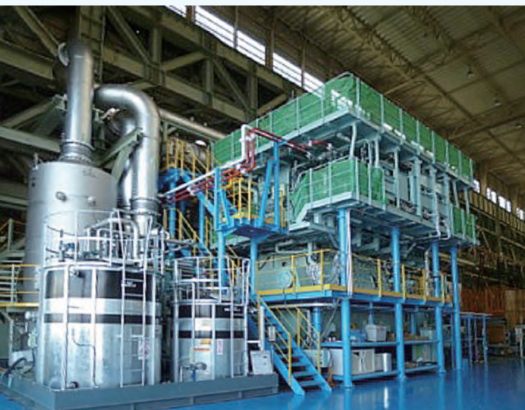
4UE-X3测试机EGR测试设备(神户造船所)
