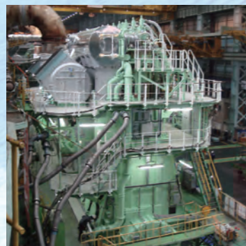
装配在斗山发动机公司制作的发动机上的MET增压器
