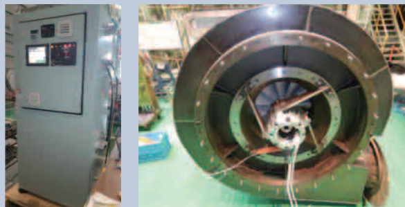
安装在MET83SE增压器上的传动轴和绕组
