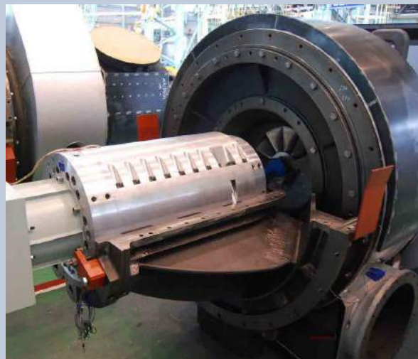
将发动机安装在下壳上的状态
