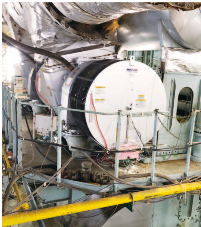
测试主机(6 X 72 DF)安装的MET 60 MBII
