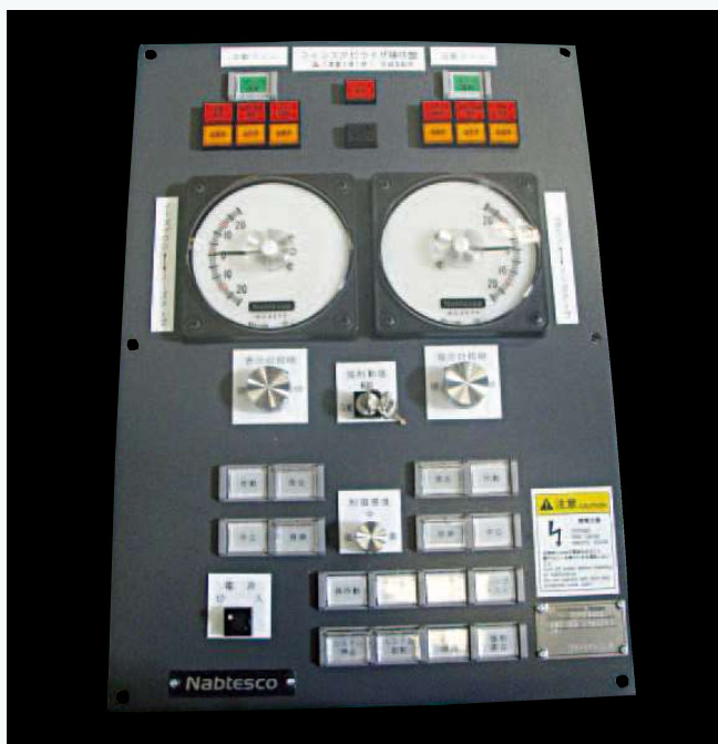
現行型制御装置操作板
