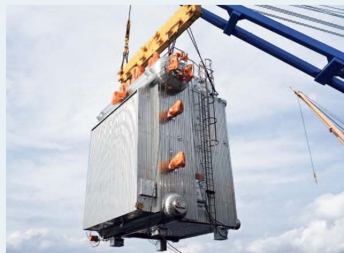
装在船上的MAC型辅助锅炉
