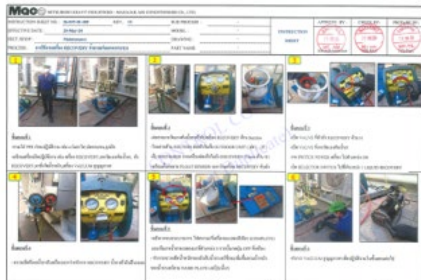
เอกสารคู่มือการทำงาน การใช้งานเครื่อง Recovery น้ำยาแอร์ออกจากระบบ (IS-MT-01-389 Rev.00)
