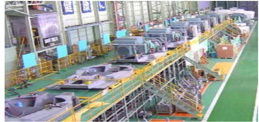
Nacelle production line
