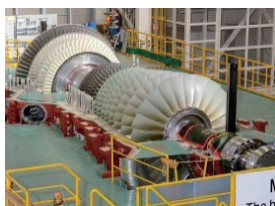
ガスタービン / 蒸気タービン
