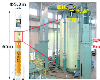
ロケットの座屈試験
