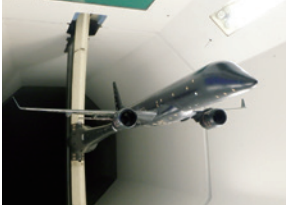
低速風洞試験設備 (計測部: 2m×2m)
