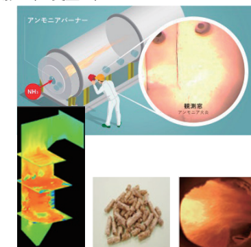
ボイラ燃焼解析とアンモニア/バイオマス専焼状況
