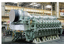
エンジン発電機
