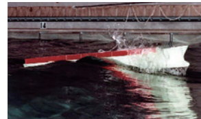
水槽試験による波浪中の安全性評価
