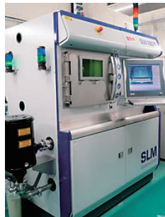
金属AM造形装置 (SLM社製、造型サイズ280mm角)
