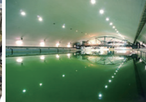
大型水槽試験設備 (全長×幅: 285m×12.5m, 160m×30m)
