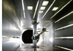
高速風洞試験設備 (計測部: 0.6m×0.6m)
