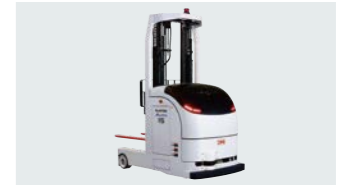
三菱ロジスネクスト(株) レーザー誘導方式無人フォークリフト
