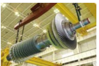
2011 世界最高効率 世界最高効率のJ形ガスタービンが実証運転で世界最高のタービン入口温度1,600°Cを達成
