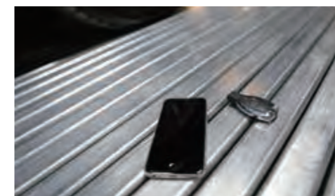
小物類が挟まりにくい配慮されたコンベア
